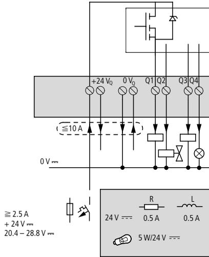
Abbildung 11: Anschließen der Transistor-Ausgänge beim Gerät EC4E-221-6D4T1
