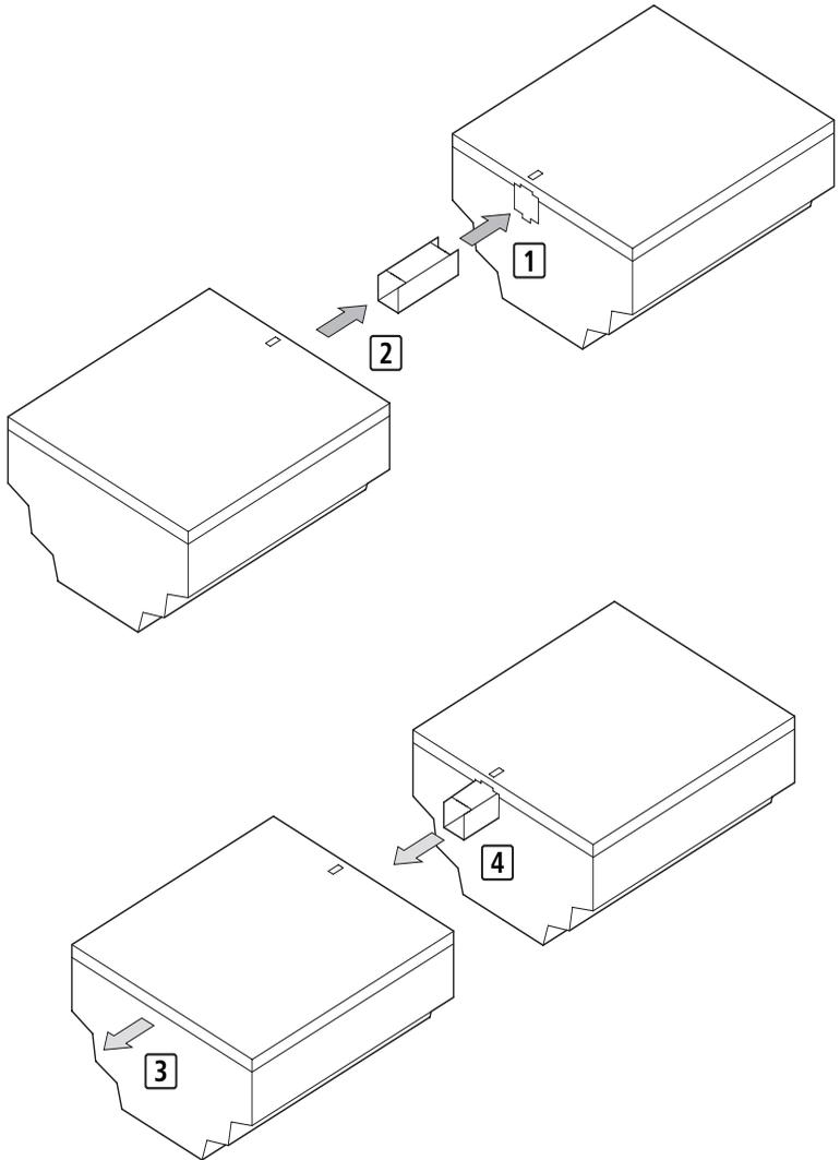
Abbildung 13: Montage (1 und 2) und Demontage (3 und 4) eines Erweiterungsgerätes
