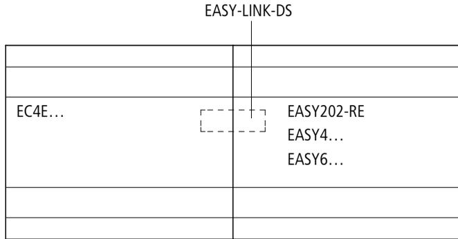
Abbildung 2: Anschluss eines Erweiterungsmoduls an das EC4E-Modul
