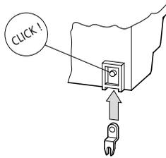
Abbildung 6: Gerätefuß einsetzen
