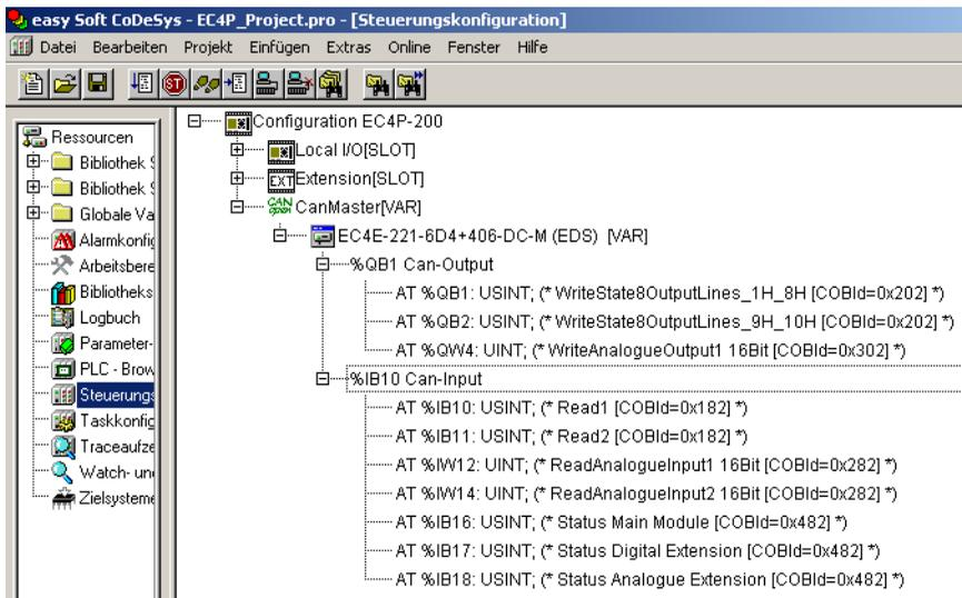
Abbildung 20: Input- und Output-Adressen des EC4E-Moduls mit dem Erweiterungsgerät EASY406-DC-ME
