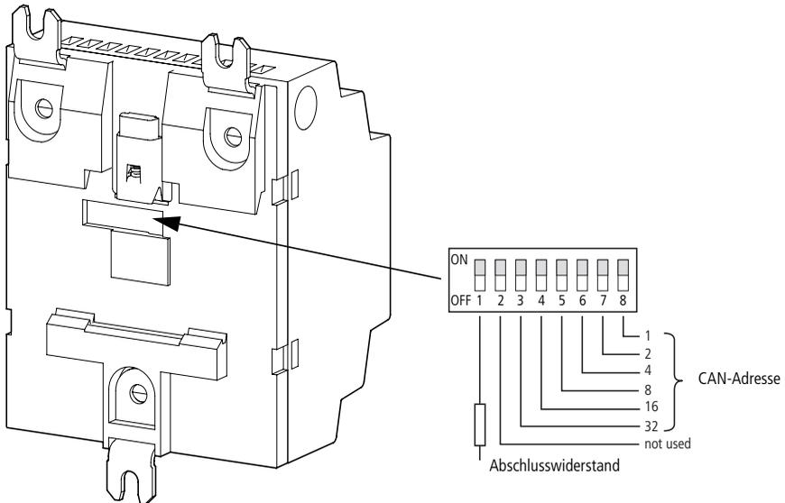
Abbildung 12: Einstellen der CAN-Adressen mit Hilfe der DIP-Schalter
