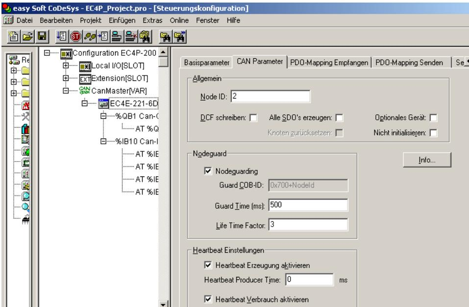
Abbildung 17: Einstellen der CAN-Adresse (Node-Id) und des Nodeguardings beim EC4E-Modul
