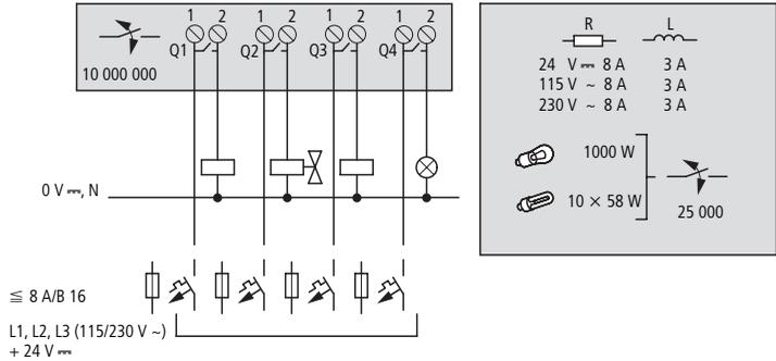
Abbildung 10: Anschließen der Relais-Ausgänge beim Gerät EC4E-221-6D4R1
